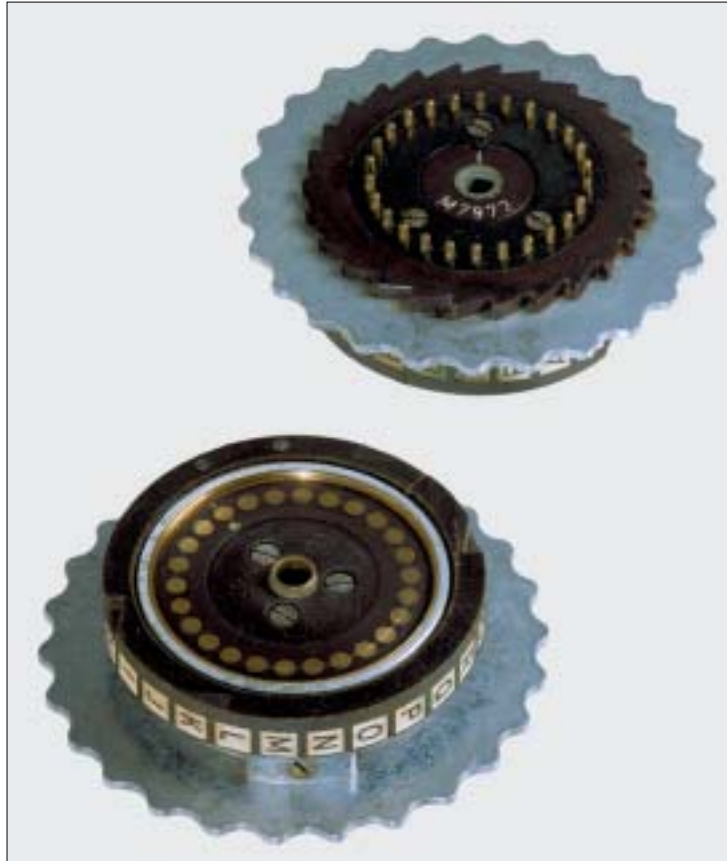
Die Rotoren der ENIGMA konnten herausgenommen und ausgetauscht werden
